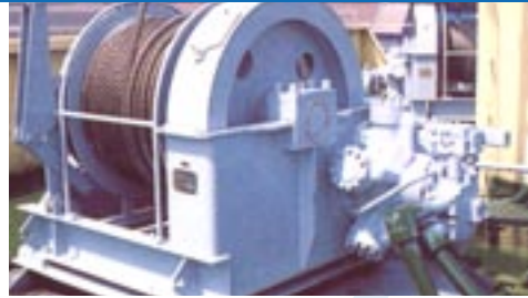
Een STAFFA motor gebruikt als lieraandrijving
